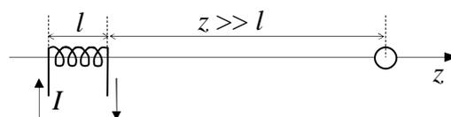
**3Б.** Внутри длинного соленоида с плотностью намотки витков  $n$ , замкнутого на резистор с сопротивлением  $R$ , расположена небольшая магнитная стрелка с магнитным моментом  $\vec{p}_m$ . Ось стрелки перпендикулярна оси соленоида (см. рис.). Какой заряд  $q$  протечёт через сопротивление  $R$  при повороте стрелки на  $90^\circ$  (в плоскости рисунка)?
